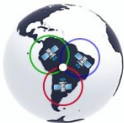
O mesmo pode ser feito com outros pontos de referência (no nosso caso, Y e Z) e assim fazer a triangulação dos pontos para determinar exatamente a sua posição. O sistema de GPS funciona da mesma forma. Este princípio é chamado de trilateração.
